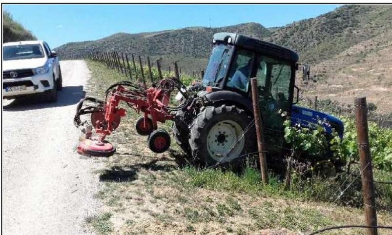
Figura 8.2 – Equipamento inter-cepas para corte da erva na linha da vinha, neste caso sem mobilização do solo, ficando a erva cortada sobre o terreno em empalhamento, em agricultura biológica (Vila Nova de Foz Côa, 2019)
