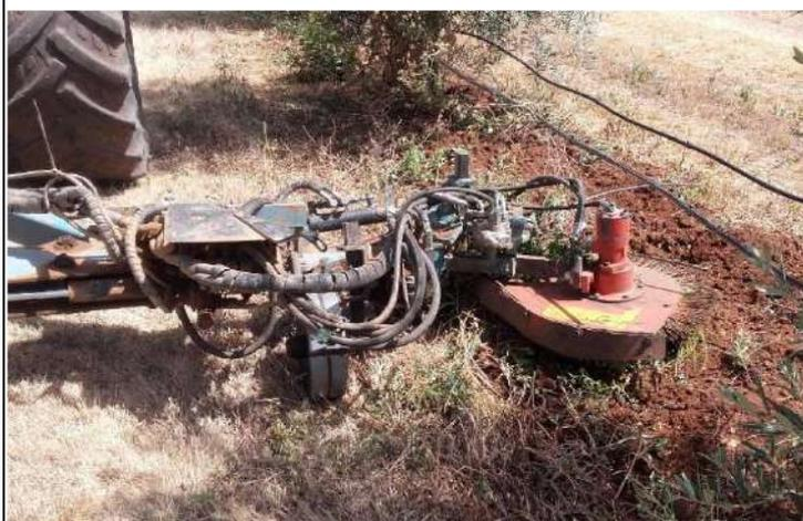
Figura 8.3 – Alfaia interfilar para eliminar a erva na linha com mobilização superficial do solo em olival intensivo sem herbicida e em agricultura biológica (Serpa, 2020)
