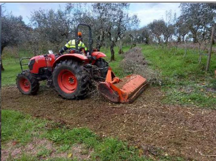
Figura 1.3 – Trituração da rama da oliveira (em vez da prática ainda dominante da queima), com destroçador de martelos, transformando um subproduto num corretivo orgânico para o solo e promovendo o sequestro de carbono que ajuda a compensar as emissões de gases com efeito de estufa (GEE) como o CO<sub>2</sub> (Ferreira do Zêzere, 20/11/2021)
